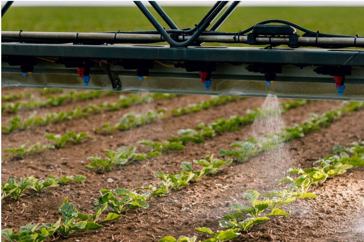
Abbildung 1: Streifenspritzung mit einer optimierten Feldspritze
