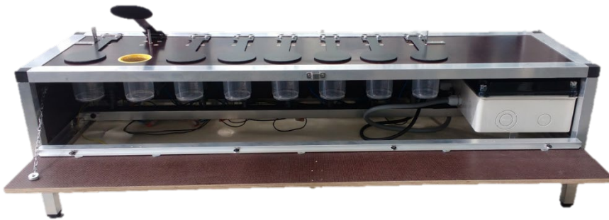
Abbildung 1: Halbautomatische Falle zur Erfassung der tages- und jahreszeitlichen Aktivität von kleinen Insekten. Die Falle wird mittels der Physical-Computing-Plattform Arduino gesteuert. Jede Klappe ist individuell steuerbar.
