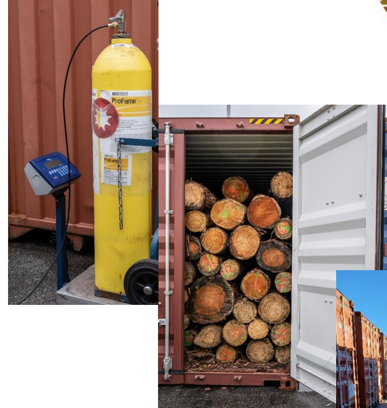
Containerbegasung von Kalamitätsholz mit ProFume im Hamburger Hafen
