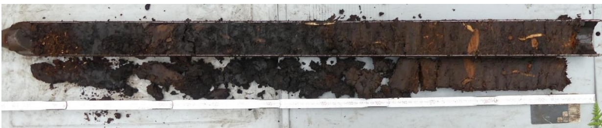
Abbildung 11: Stechbohrer (Firma Eijkelkamp) mit 1 m langem Bohrkern.
