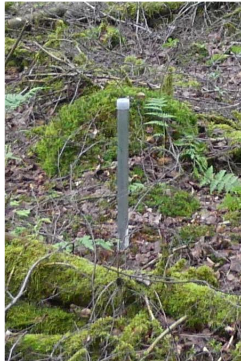
Abbildung 21: a) Installation der Geländehöhenänderungspeilstange im Moorkörper; b) Foto einer im Gelände eingebrachten Geländehöhenänderungspeilstange
