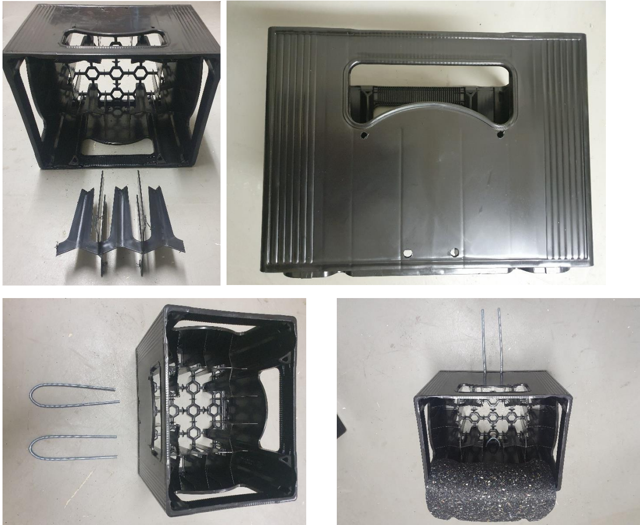
Abbildung 25: Herstellung der verankerbaren Volumenelemente aus Getränkekisten: a) herausgelöste Getränkehalterungen; b) Durchbohrungen der Getränkekistenwand; c) zwei Krampen, gebogen aus Gewindestangen; d) Kiste mit Deckel und eingeschobener Krampe
