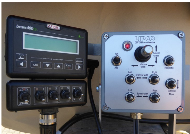
Abb. 4: Armatur ARAG bravo 180 s, sowie Schaltkasten für die Bedienung der Tunnelwände.
