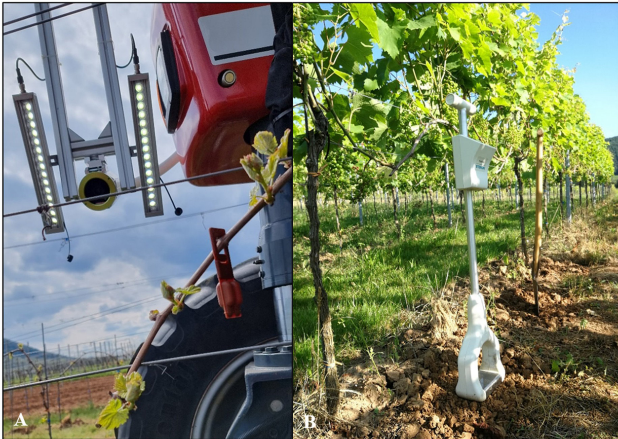
Abb. 1: Sensordatenerfassung im Weinberg. A ) PHENObox in der Front des PHENOLINERS (umgebauter Traubenvollernter, genutzt als Phänotypisierungsplattform mit verschiedenen Sensoren, GPS, Rechnern). B ) digitaler Bodenspaten der Firma „Stenon“.
