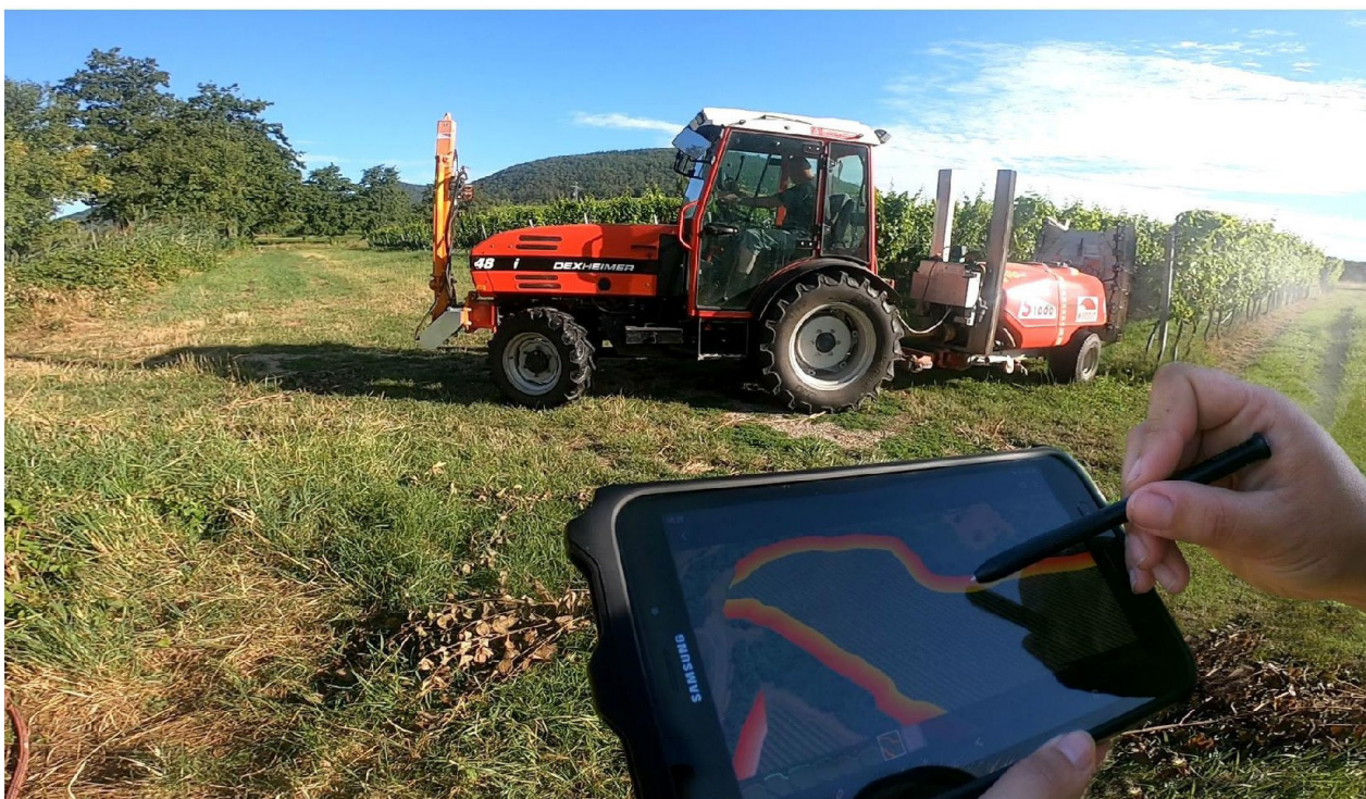
Abb. 3: Beispiel einer Applikationskarte auf dem Tablet die die „Pufferzone“ zu Nichtzielflächen optisch darstellt (Foto: Anna KICHERER, JKI).
