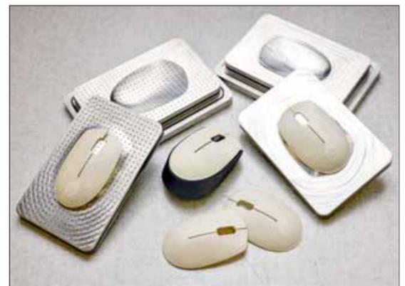
Versuchsweise hat Empa-Forscher Thomas Geiger Gehäuseteile für Computermäuse aus Cellulosefasern gefertigt. Die Oberflächen glänzen wie edles Elfenbein; die Bauteile sind komplett kompostierbar. Fotos: Empa
