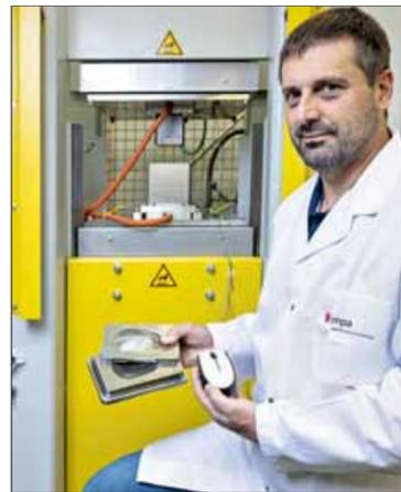
Faserspezialist Thomas Geiger vor einer Spezialpresse mit den Werkzeugen: Bei 150 t Druck werden die Cellulosefasern zunächst entwässert und in einem zweiten Arbeitsgang verfestigt.
