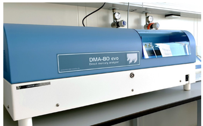
Abbildung 1: Analytisches Messgerät für Quecksilber: Direct Mercury Analyzer (DMA 80 evo).
