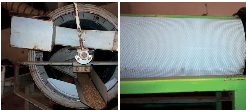
Abb. 8. Trieur; links frontale Ansicht, rechts seitliche Ansicht
