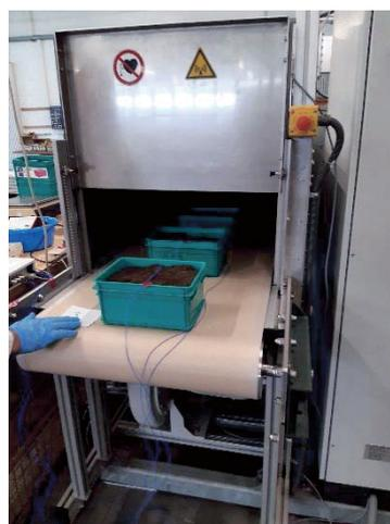
Abb. 9. Hochleistungs-Magnetron mit Förderband
