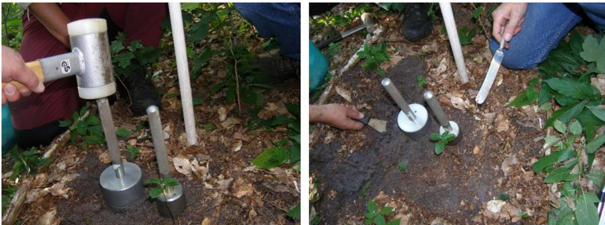
Abbildung V-5: Beprobung des Oberbodens mit Hilfe eines Stechzylinders
