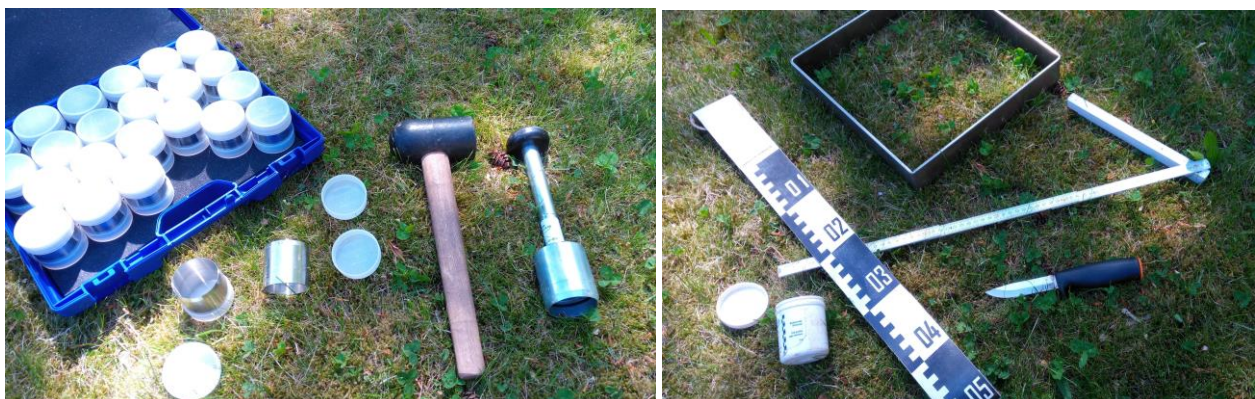
Abbildung V-2: Ausgewählte Geräte zur Entnahme von Boden- und Humusproben
