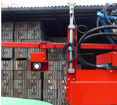
Abb. 3: Die beiden Ultraschallsensoren sind an der Längstraverse montiert und tasten die Laubwand im rechten Winkel zur Fahrtrichtung ab.
