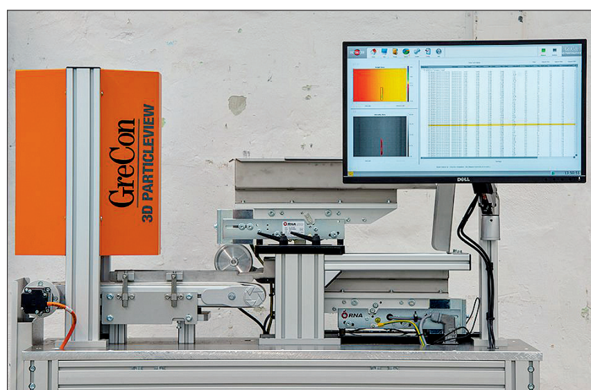
Abbildung 3 Laborgerät „3D Particleview“ zur dreidimensionalen Spanvermessung
