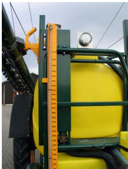
Abb. 4: Arbeitsplattform und Behälterinhaltsskala auf der rechten Geräteseite
