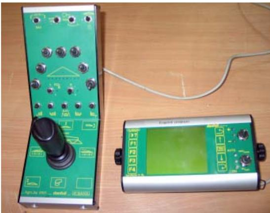
Armatur bestehend aus dem Bedienteil „AgroJoy 2001“ und dem Terminal „AgroMaster III XL“ der Firma V-technik. Über das Bedienteil „AgroJoy 2001“ sind sowohl die Hydraulikfunktionen (Heben/Senken, Ein-/Ausklappen, Hanganpassung), die Gebläseleistungsverstellung wie auch die Zentralschaltung oder Teilbreitenschaltung möglich.
