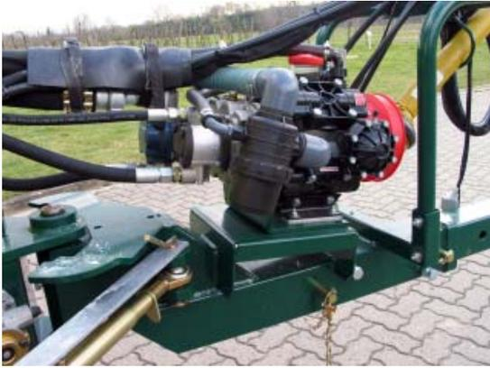
Vierkammer-Membranpumpen Typ AR 185 bp (Leichtmetallgussgehäuse). Antrieb über Gelenkwelle oberhalb der Deichsel.
