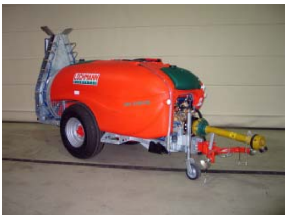
Abb. 2: Fahrgestell mit Knickdeichsel und Stützrad.
