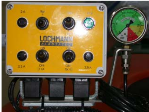
Abb. 9: Fernbedienung mit Kippschaltern und Fernmanometer.
