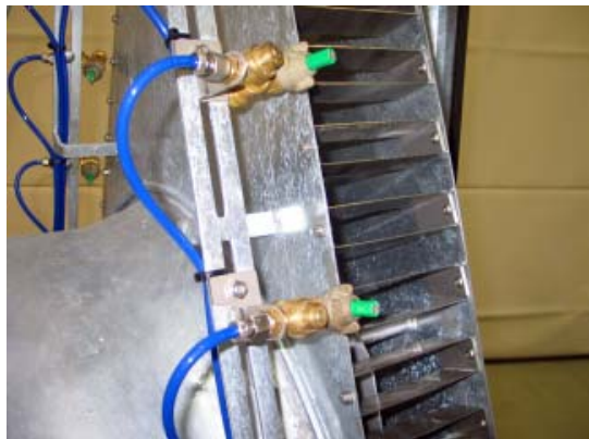
Abb. 8: Doppel-Schwenkdüsenkörper im Langloch vor der Gebläseaustrittsöffnung. Flüssigkeitsversorgung über Verteiler und Einzeldüsen-schläuche.
