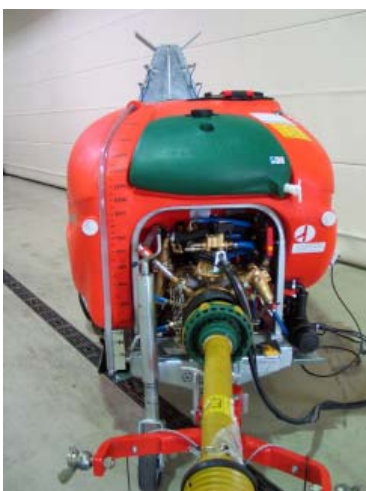
Abb. 3: Der Behälterfüllstand kann auch von vorn gut abgelesen werden.
