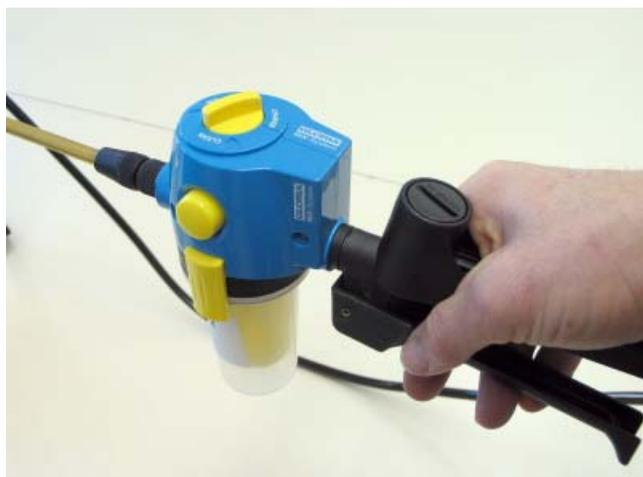
Abb. 3: Die Direkteinspeisung kann an den Handgriff von Spritzgeräten adaptiert werden.
