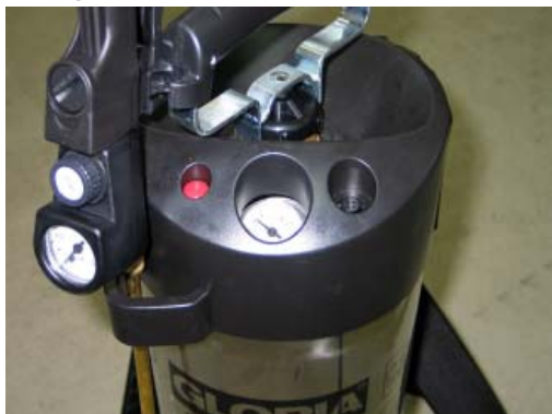
Abb. 2 : Spritzgerätekopf mit Luftpumpe, Manometer und Druckenlastungsventil.
