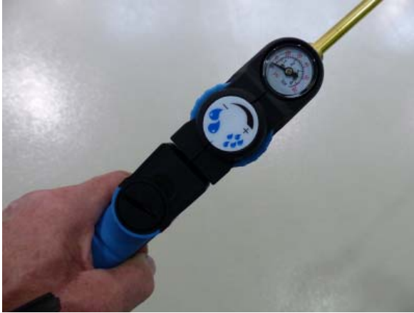
Abb. 5: Der Handgriff mit Manometer und Druckregelventil liegt gut in der Hand.
