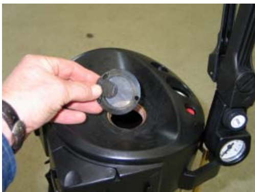
Abb. 2 : Spritzgerätekopf mit Luftpumpe, Manometer und Druckenlastungsventil.
