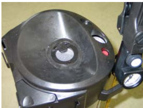
Abb. 3 und 4: Das obere Behälterteil ist als Fülltrichter ausgeformt. Der Siebeinsatz wird bei Nichtgebrauch an der Seite eingeklippt.
