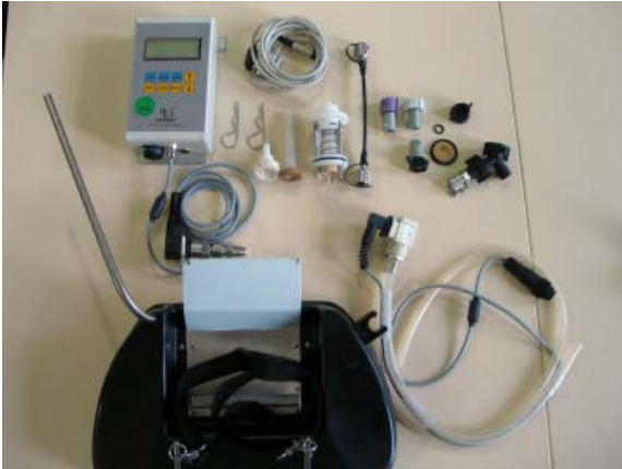
Abb. 2: Lieferumfang: Messwertrechner, Durchflussmesser, Adapter, Tragehilfe.
