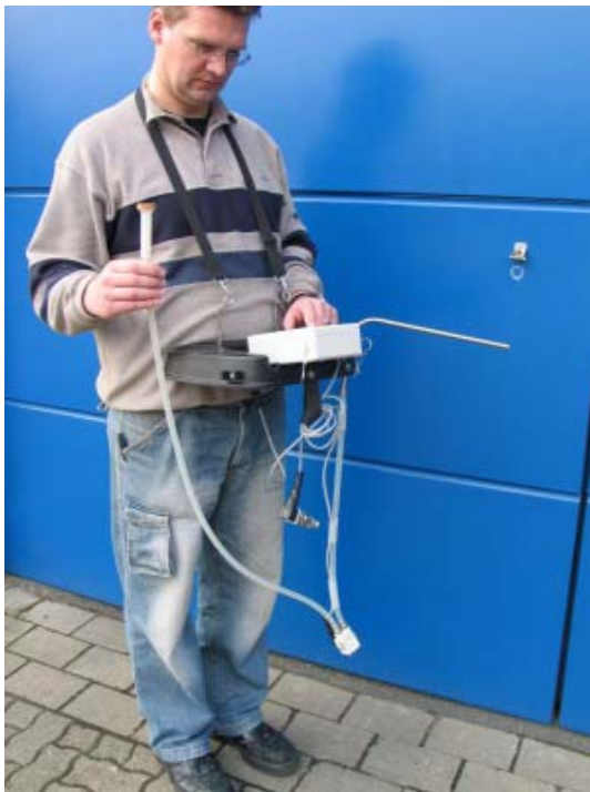
Düsendurchflußmessgerät Herbst FHK 3.30
