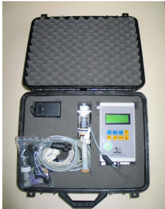
Düsendurchflußmessgerät Herbst FHK 3.30
