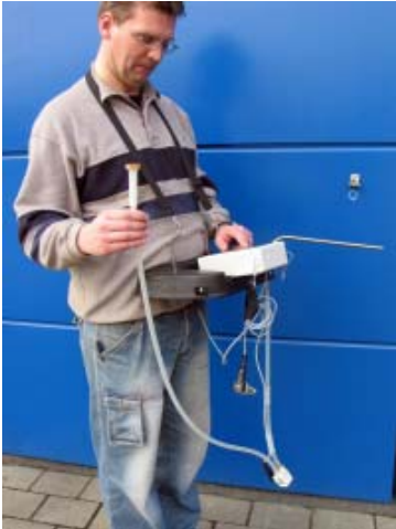
Abb. 5: Die Tragehilfe nimmt alle erforderlichen Messgeräte auf und führt die gemessene Wassermenge über ein Edelstahlrohr von Anwender weg.
