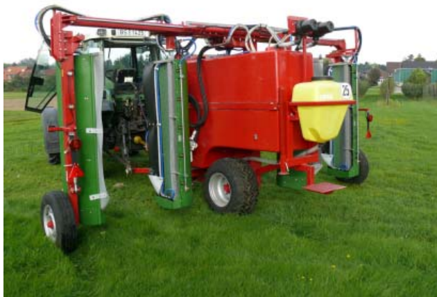
Abb. 2: Die Rahmen der Gebläseeinheiten sind tragende Teile des Fahrgestelles.
