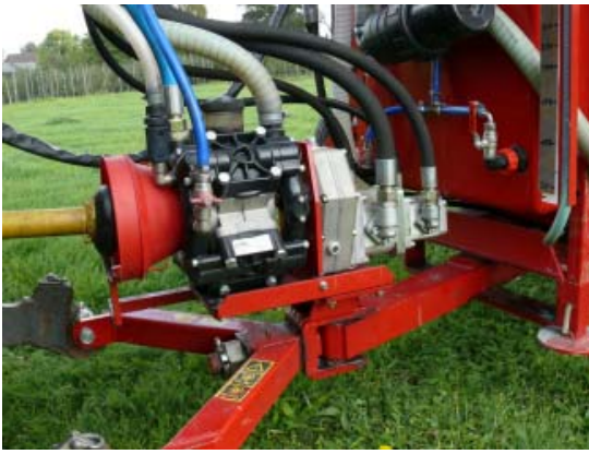
Abb. 4: Die Hydraulikpumpe ist direkt an die Membranpumpe abgeflanscht.
