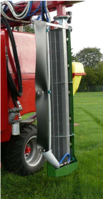
Abb. 5: Gebläseeinheit mit Tangentialgebläse, Sumpf und Spritzschutz.
