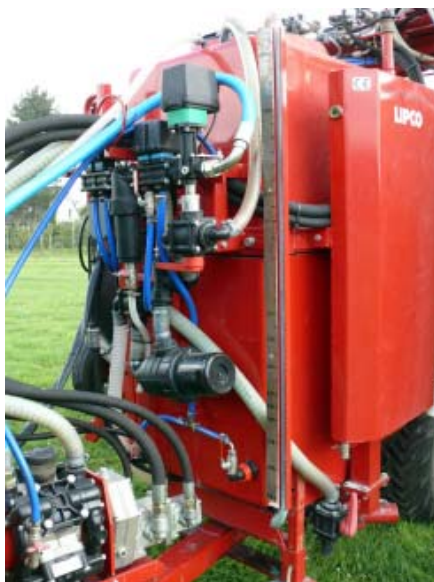
Abb. 6: Sowohl Spritz- als auch Hydraulikfunktionen sind in der Fernbedienung integriert.
