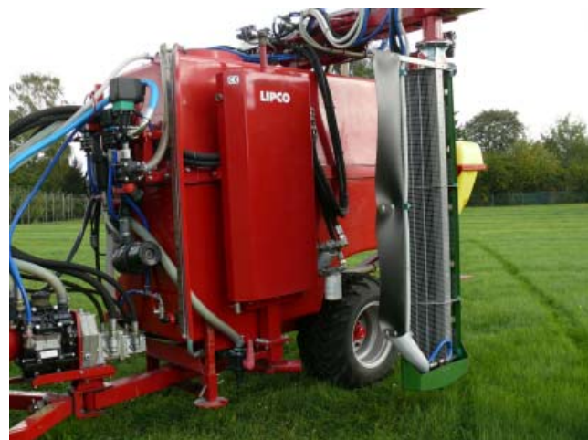
Abb. 3: 1000-l-Behälter aus Polyester mit Volumenskala vorn links. Armatur im Frontbereich, Ölbehälter linksseitig.
