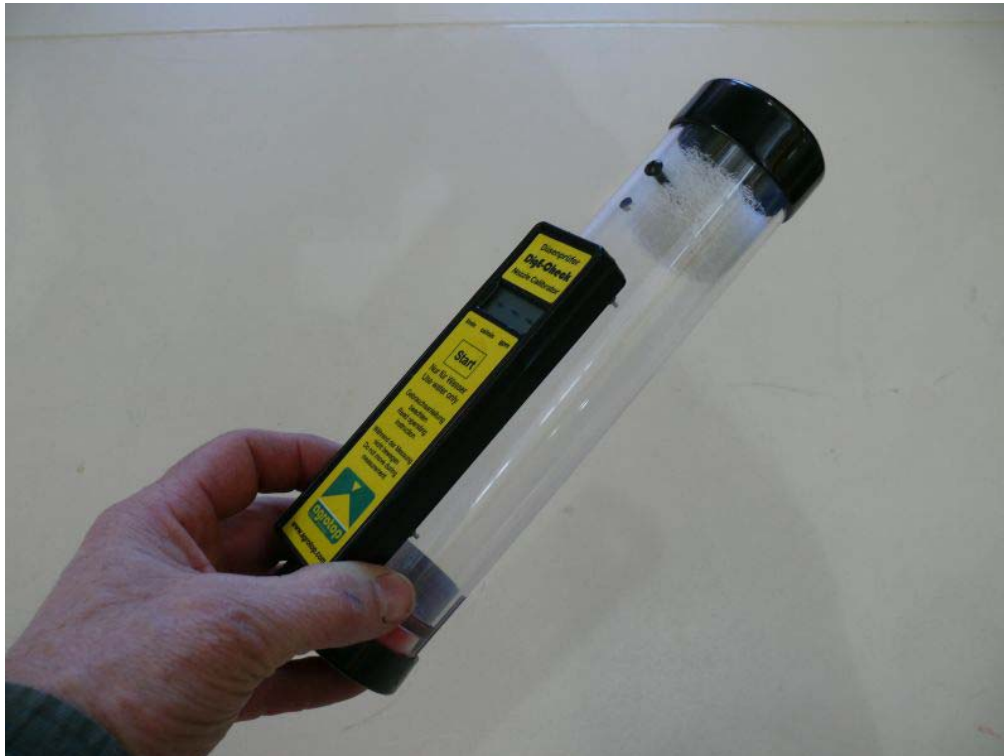
Messeinrichtung Einzeldüsentester „DigE-Check“
