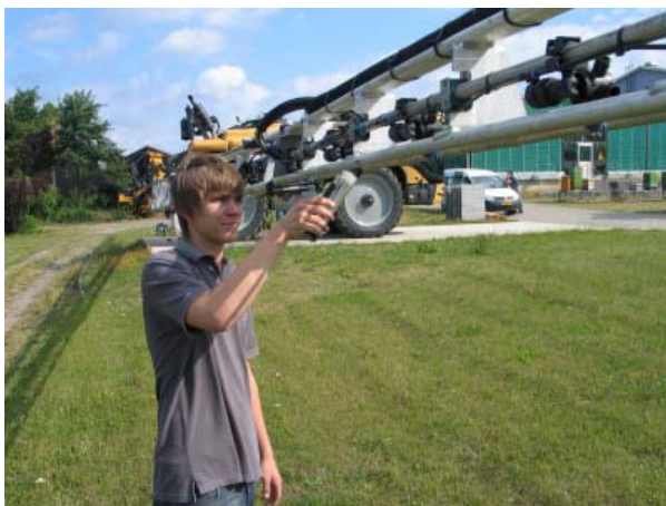
Abb. 2: Der Einzeldüsentester lässt sich leicht handhaben und ist sofort einsatzbereit
