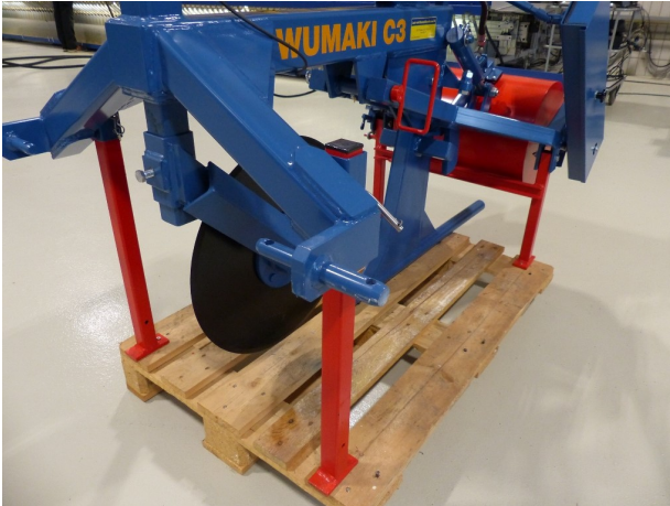
Abb. 2: Die Köderlegemaschine wird bei Nichtgebrauch auf vier Füßen abgestellt.
