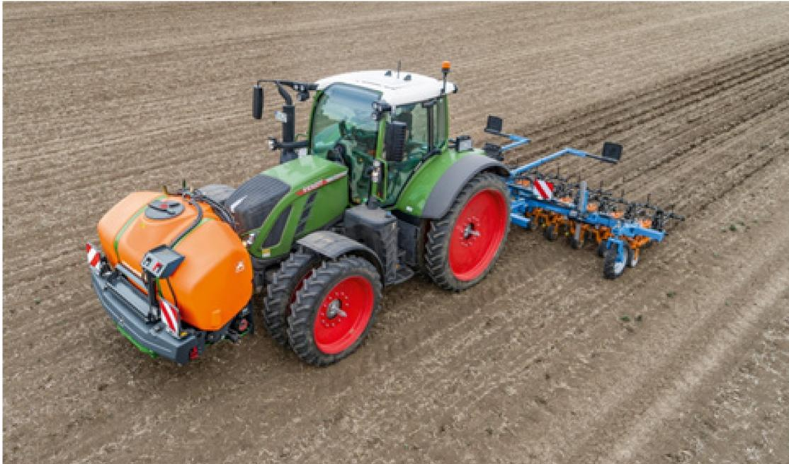
**Bild 3:** Hacke-Bandspritze der Firmen Amazone und Schmotzer. [3]
