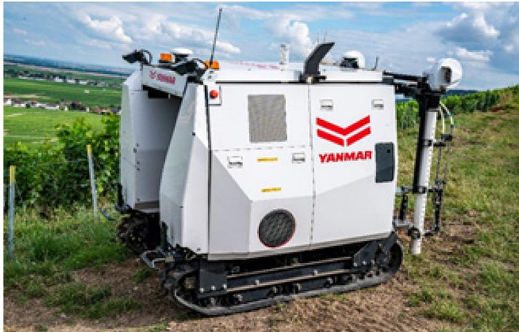
**Bild 10:** Yanmar YV01 autonomes Weinbautunnelsprühergerät. [24]
