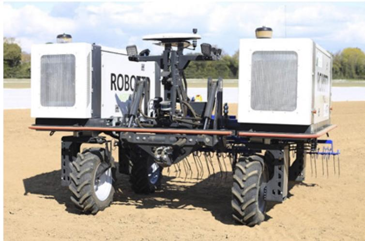
**Bild 7:** Agointelli 150D mit Striegelanbau zur Unkrautbekämpfung. [11]
