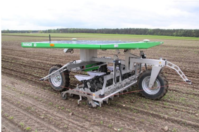
**Bild 4:** Farmdroid bei der mechanischen Unkrautbekämpfung in Zuckerrüben. Die Position der Pflanzen wurde zuvor bei der Aussaat aufgezeichnet. [5]
