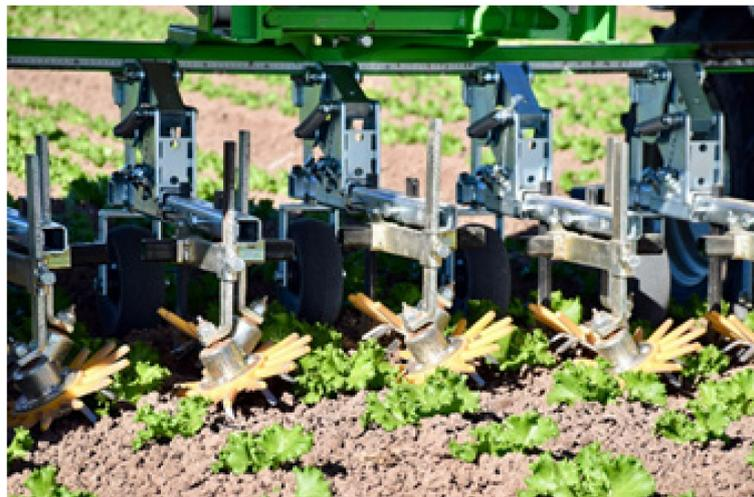
**Bild 6:** Fingerhacke am autonomen Feldroboter Dino. [7]
