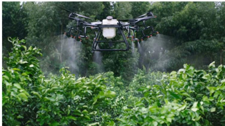
**Bild 11:** DJI Agras T30 Drohne zum Versprühen von Pflanzenschutzmitteln. [25]
