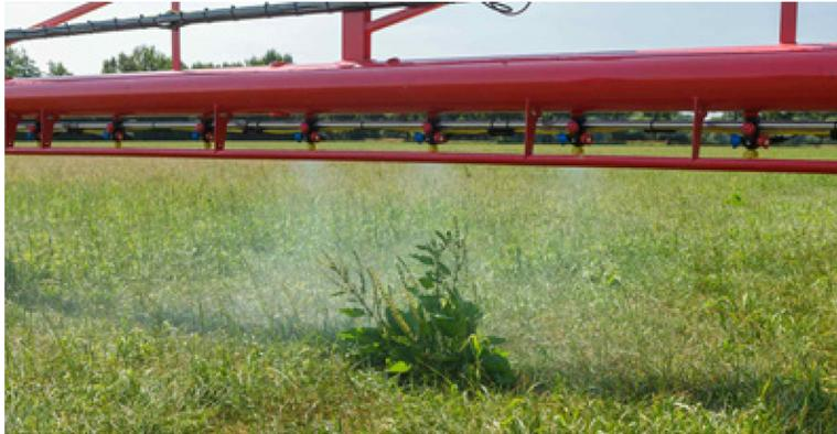
**Bild 8:** Agrifac Camera sprüht „green on green“. [19]
