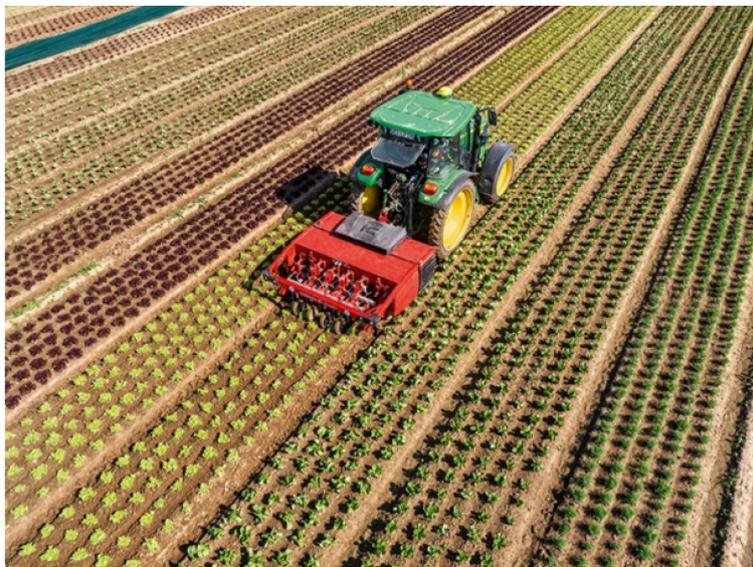
**Bild 2:** Steketee IC-Weeder mit Pflanzenerkennung. [2]
