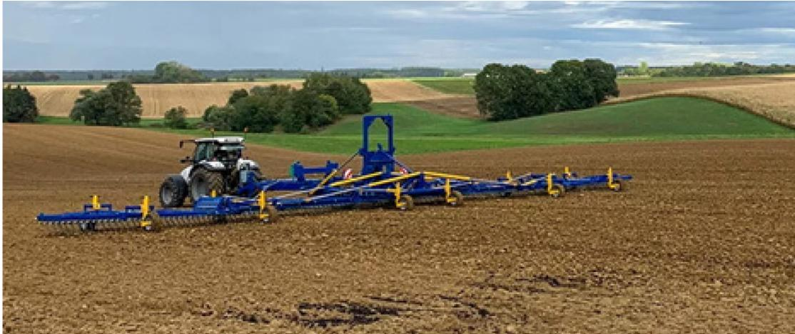
**Bild 1:** Treffler Präzisionsstriegel mit 29 Metern Arbeitsbreite. [1]
