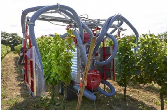
Abb. 1 UV C-Prototyp für die Behandlung von Reben
