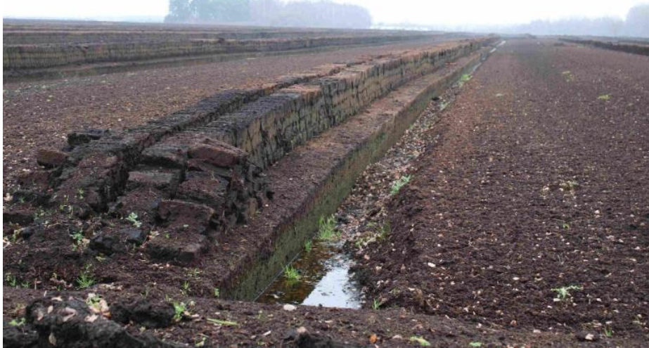
Foto A/14: Torfabbau im Stechverfahren westlich der Lichtenhorster Straße (Aufnahme: Thünen-Institut/Bathke, Januar 2021)
