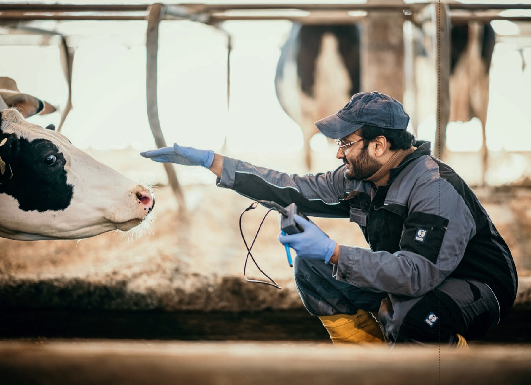
Der Ingenieur Aditya Rawat erfasst Temperatur, pH-Wert und Luftgeschwindigkeit am Boden eines Versuchsstalls in Dummerstorf. Mithilfe dieser Parameter modelliert das Team des Projekts „EmiMin“, wie ein innovatives Bodensystem dazu beiträgt, Ammoniak-Emissionen zu vermeiden.
