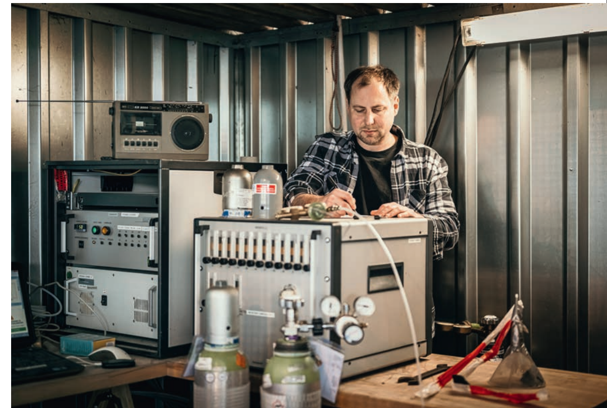
Wie wirken die Maßnahmen zur Minderung von Kohlendioxid, Methan, Ammoniak, Lachgas und weiteren Spurengasen? Dr.-Ing. David Janke vom ATB überprüft die Messungen im Versuchsstall.
