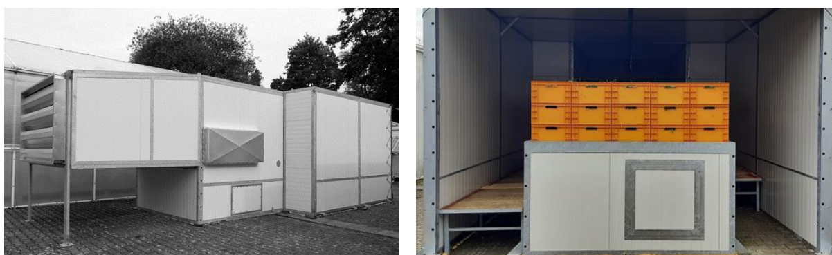
Abbildung 1: Der modulare Trockner-Prototyp an der Universität Hohenheim (links) und die Trocknungsboxen im Inneren des Trockners (rechts)
