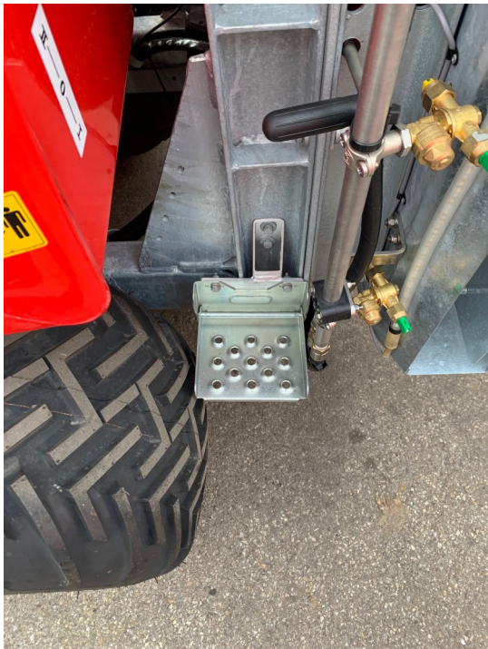
Abb. 2: Die Gebläsedrehzahl lässt sich über eine Verlängerung leicht von außen einstellen. Eine Klappstufe erleichtert die Erreichbarkeit des oberen Gebläsebereiches.
