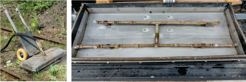
Abbildung 2 Heißwassergerät auf der Gleisfläche und von der Unterseite.
