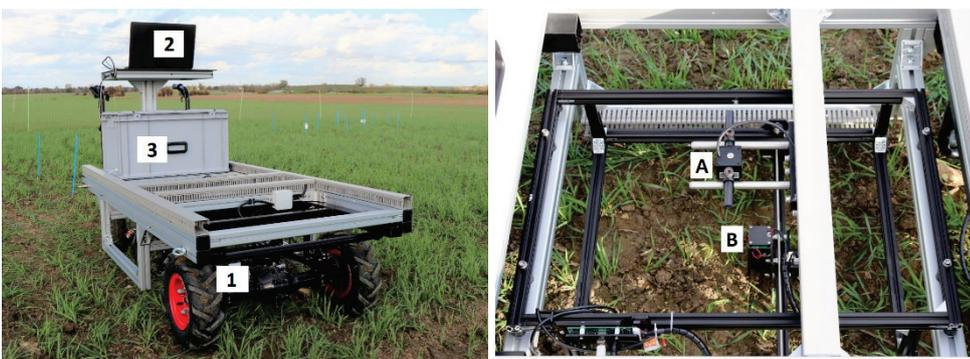
**Abbildung 3** Erster Prototyp des Laserbehandlungsgeräts. Links: Trägerfahrzeug (1) mit Steuereinheit für den Laserapplikator (2) und Steuerungselektronik (3). Rechts: Laserapplikator mit Kamera (A) und auf einem Achssystem montiertes Lasermodul (B).
