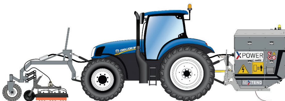
Abbildung 1 XPR-Reihenapplikator bestehend aus Frontapplikator und Energieversorgungseinheit der Firma Zasso (Zasso, 2021).
