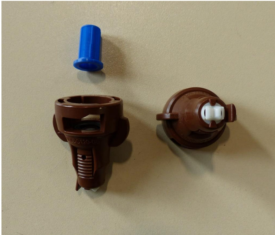
Doppelflachstrahldüse John Deere PSAULDCQ2005 (Keramik, kunststoffummantelt, braun)
