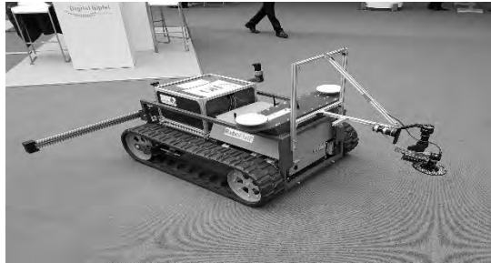
Abb. 2: Roboterplattform mit optischem Sensor und Bekämpfungswerkzeug
