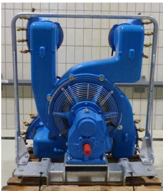
Bild 2: Der vordere Lufteintritt wird zu ca. 25% durch das Getriebe verdeckt. Am Getriebe der Schalthebel für die Getriebe-stufen. .
