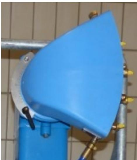
Bild 4: Die Luftdüsen sind schwenkbar über Knebelschrauben arretiert.
