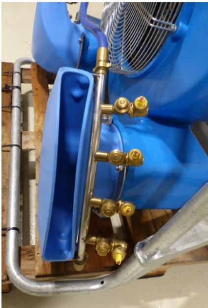
*Bild 5: Die Düsenkörper sind vor den Luftdüsen montiert. Die Flüssigkeitsversorgung erfolgt jeweils pro Seite.*
