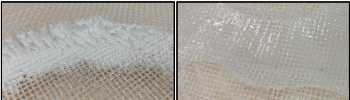
Abb. 16: Vollständiges Umhüllen der Netzstücke durch Hochleistungsdichtstoff auf STP-Basis (A) und Silikon (B) (Fotos: © C. Augel, LTZ Augustenberg)
