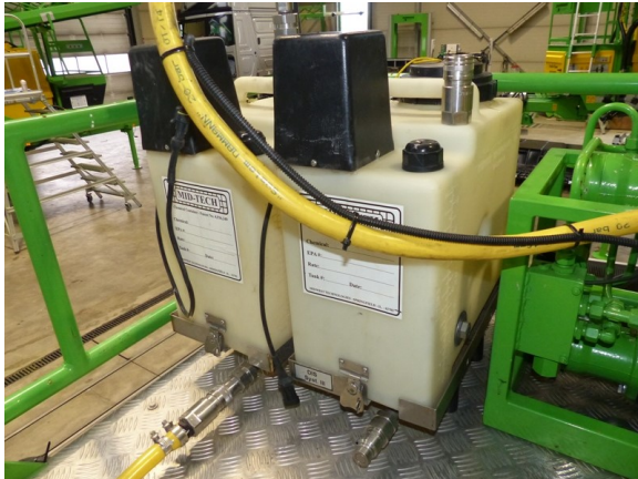
Abb. 3: Die Wechselbehälter (26 l) sind mit tropffreien Schnellverschlüssen und jeweils einem Rührwerk versehen.
