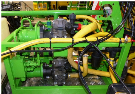
Abb. 7: Die Spülpumpen werden hydraulisch angetrieben.
