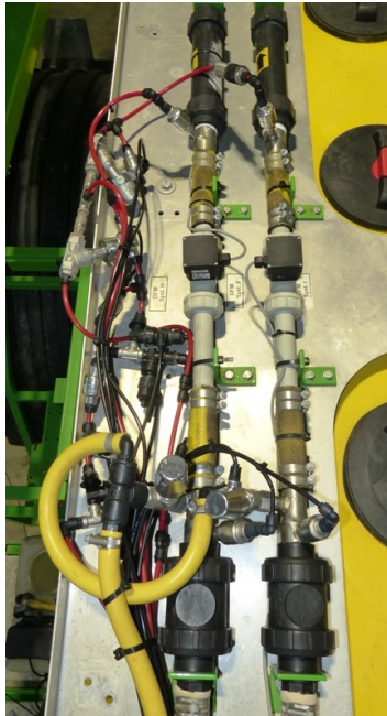
Abb. 5 und 6: Einspeisebereich (oben) oberhalb des Behälters mit Rückschlagventil, Durchflussmesser und Mischkammer (oben rechts).
