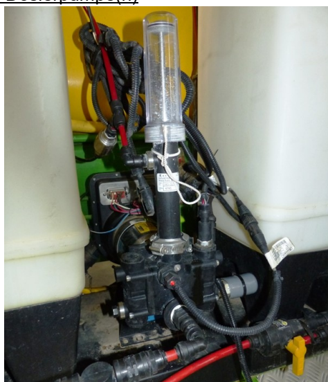
Abb. 2: Elektrisch angetriebene Kolbenpumpe für die Dosierung des flüssigen Pflanzenschutzmittels (Raven „SidekickPro“).
