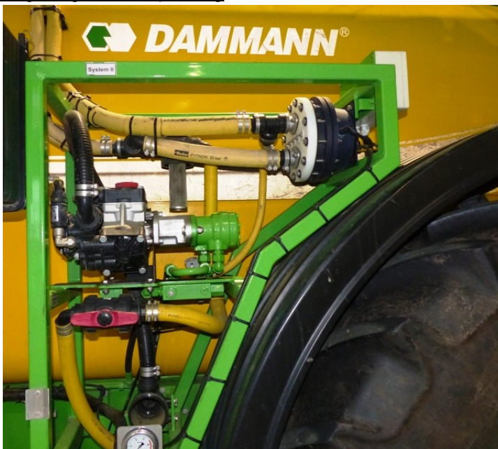
Abb. 4: Eines der zwei separaten Spritzsysteme mit Pumpe, Regler und Druckfilter ist an der linken Geräteseite angeordnet.
