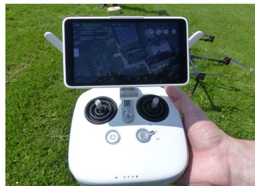
Die aktive Flugplanung umfasst das Setzen des Ausgangspunktes (Start- und Befüllplatz), die Eckpunkte für den zu behandelnden Bereich und weitere am Terminal zu setzende Wegmarken. Ferner kann die Flugrichtung und die Arbeitsbreite (Zeilenbreite) eingegeben werden, diese bestimmt den Versatz mit dem das UAV die einzelnen Behandlungsbahnen abfliegt.
