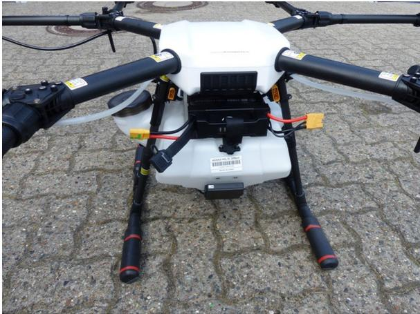
UAV mit 8 Rotoren, Antrieb über Einzelmotoren an den Rotoren. Aktive Kühlung der Motore über gefilterte Umgebungsluft und Kleingeläse, Verteilung der Kühlluft im Ausleger. An vier der acht Rotoren befinden sich jeweils Halterungen für die vier Düsen (Lechler IDK 90-025 C) mit Membranrückschlagventil und Düsenfilter mit 0,15 mm Maschenweite. Landegestell mit zwei Kufen mit 500 mm Länge, Abstand zwischen den Kufen 452 mm.
