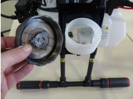
*Bild 5: Die Einfüllöffnung hat einen Durchmesser von 80 mm. Der Deckel weist einen Druckausgleich auf.*
