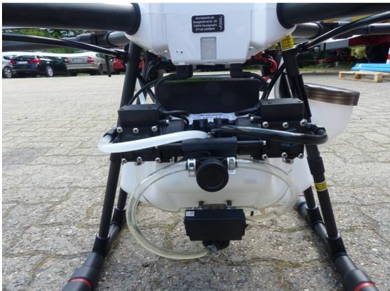
*Bild 6: Die Pumpen und der Akku-Pack sind oberhalb des Behälters angeordnet.*
