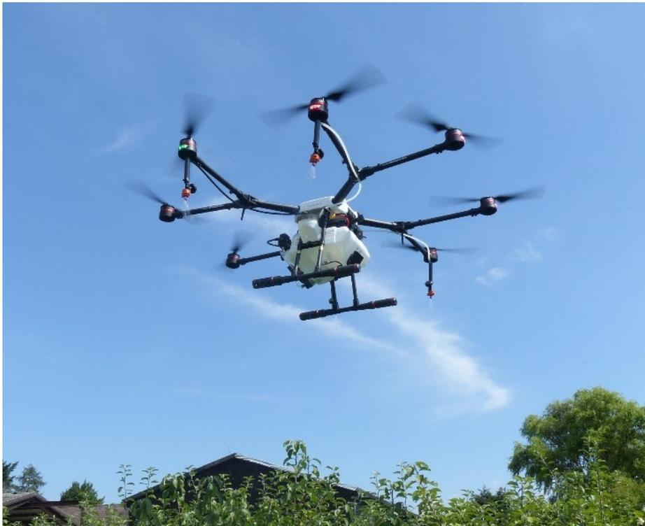
**Spritzeinrichtung mit unbemanntem Flugobjekt (UAV) Type DJI Agras
