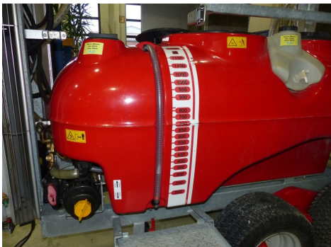
Abb. 15: Seitliche Skala mit Füllstandschlauch.
