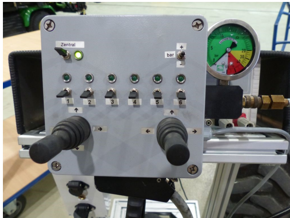
Abb. 13: Terminal (Schaltkasten) mit Fernmanometer sowie den Kipphebeln für die Schaltung der Ventile und Kreuzhebel für die Hydraulikfunktionen.
