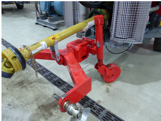
Abb. 2 und 3: Fahrgestell mit Tandemachse, Tangentialgebläse und Reflektoren an einem Hilfsrahmen. Die Anhängung erfolgt über Knickdeichsel (Kat. I oder II).
