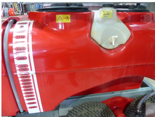
Abb. 4: Behälter aus Polyester mit 1000 l Nennvolumen und seitlicher Skala.
