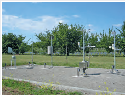
Wetterstation und Sporenfalle auf dem Versuchsfeld des Instituts Weather station and spore trap in the research orchard of the Institute
