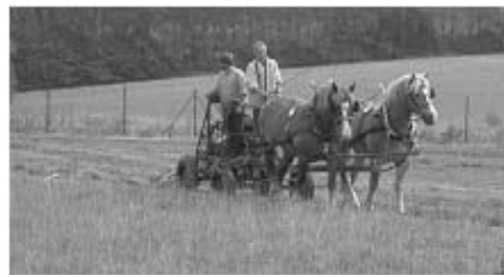
Abb. 2 Pintow Power Cart mit Busatis Doppel- messermähwerk; Pintow Power Cart with Busatis doubleknife-mower (Foto: Ralf Zauner)
