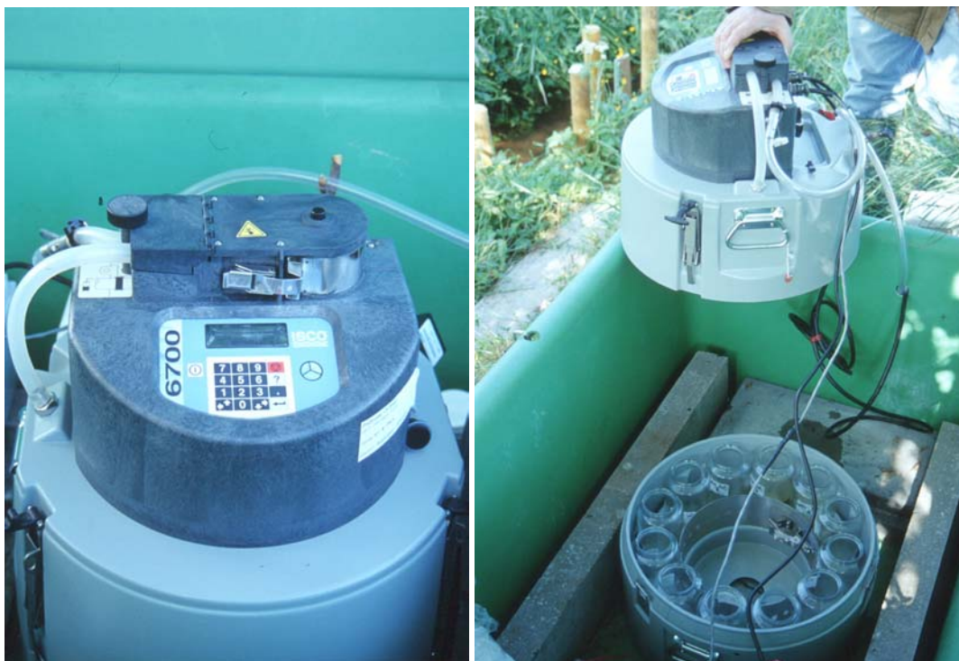
Abb. 2 Wasserprobenehmer mit Steuerungsmodul und Pumpentechnik; Analysengang der Multimethode für die Wasserproben
