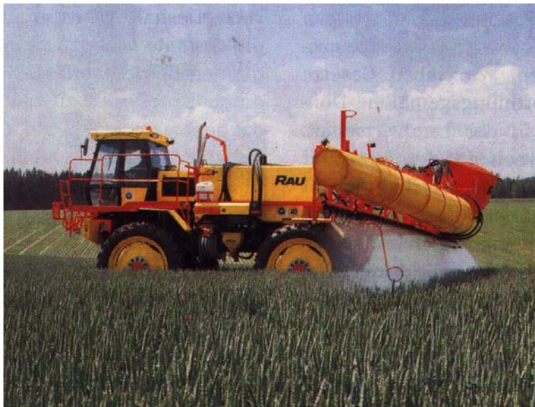
Abb. 4 Luftunterstützte Pflanzenschutzspritze mit abtriftarmen Injektordüsen
