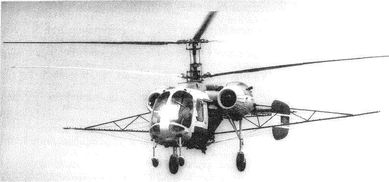
Abb. 23: KA-26 zur Ausbringung flüssiger und fester Agrochemikalien
