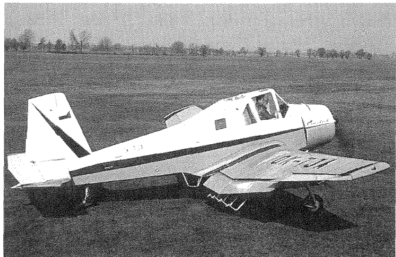
Abb. 14: Agrarflugzeug Z-37 zur Ausbringung von flüssigen und festen Agrochemikalien
