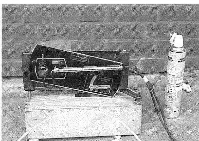
Abbildung 22: Schrägrohrmanometer für Drucktest, rechts daneben Polyurethanschaum-Dose
