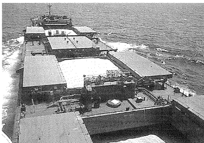
Abbildung 20: In-Transit-Begasung eines seegehenden Schiffes mit \text{PH}_3
