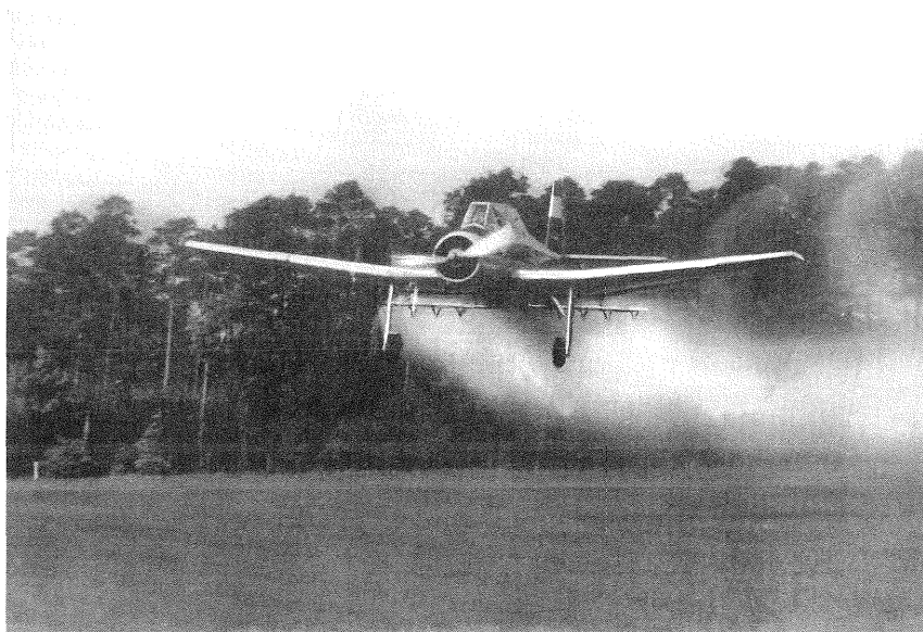
Bild 14: Die Z-37 war mit 550 l Brühezuladung und bis zu 40 m Arbeitsbreite das effektivste Agrarflugzeug im Pflanzenschutz
