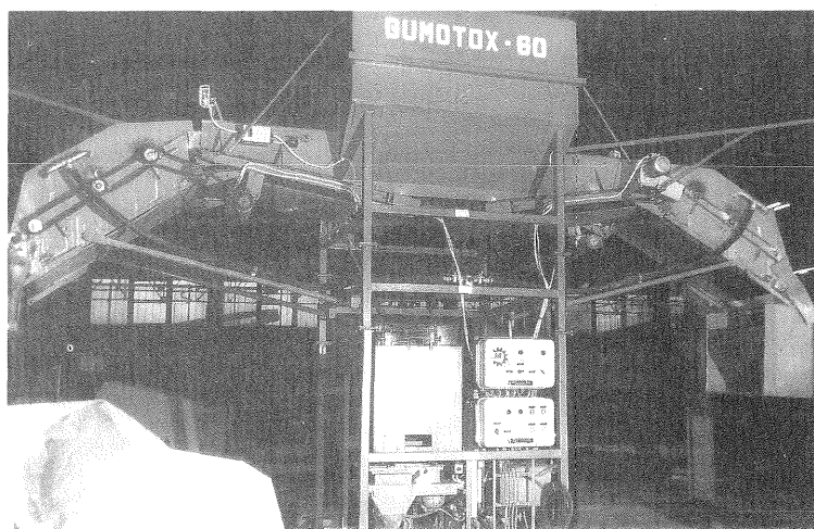
Bild 11: Die Kartoffellagerung in großen Aufbereitungs-, Lager- und Verarbeitungsanlagen erforderte eine Beizung bei der Einlagerung mit leistungsfähigen Pflanzkartoffelbeizern. Im Bild: Gumotox 60 aus Ungarn
