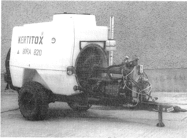
Bild 9: Die Kertitox-Bora aus Ungarn war ein Pflanzenschutzgerät der 2. Generation, durch die erhebliche Fortschritte bei der Applikationsqualität erzielt wurden
