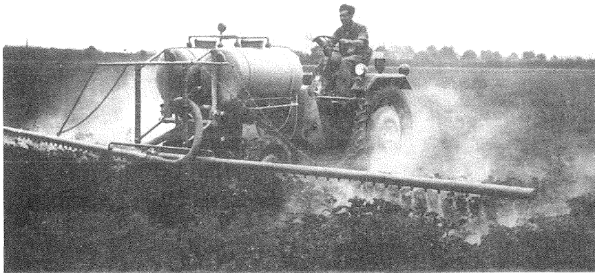
Bild 2: Auch durch das Stäubegerät zum Pflanzenschutzgerät S 293 am Geräteträger wurden die prinzipiellen Nachteile des Stäubens nicht vermieden
