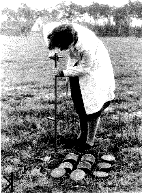
Abb. 20: Zur Bodenprobenentnahme wird mit einem Stechrohr eine Erdsäule von 0-30 cm Tiefe ausgestochen.
