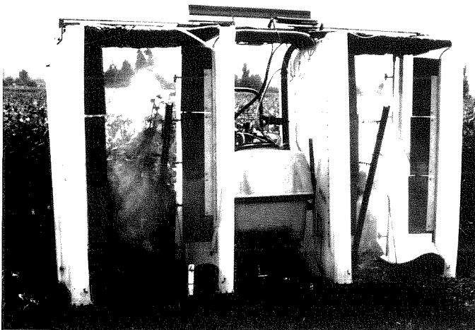
Bild 10: Heutige Bauart eines Weinbauspritzgerätes mit Rückführung
