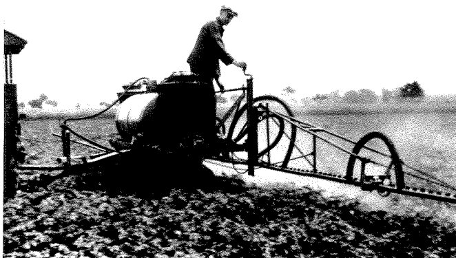
Bild 4: Schaumnebelgerät; hoher Wasseraufwand beim Spritzen führte zu Überlegungen, einen Teil des Wassers durch einen Trägerluftstrom zu ersetzen bzw. den Wirkstoff in Schaumform mittels geringer Luftmengen auszubringen.
