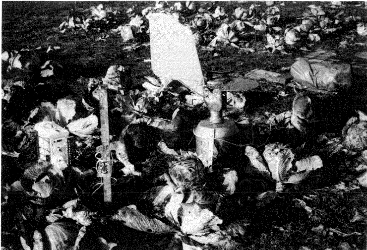
Abb. 6 Eine BURKHARD-Sporenfalle im Einsatz, neben der Falle ist der LUFFT-Blattnässeschreiber zu erkennen.
