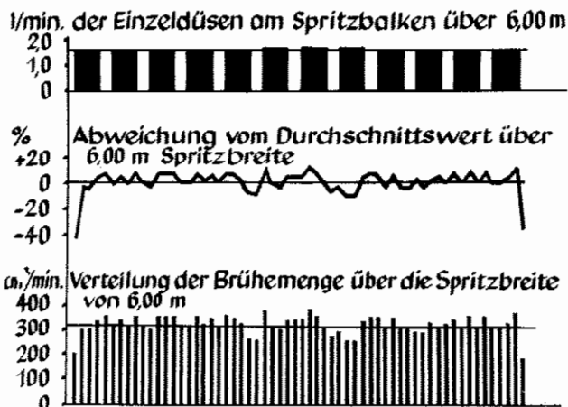
Abb. 3. Spritzgestängetest wie Abb. 1 mit guter Brühverteilung. (Das gleiche Gestänge wie bei Abb. 1) Abweichungen vom Durchschnittswert nur noch bis 10 %.
