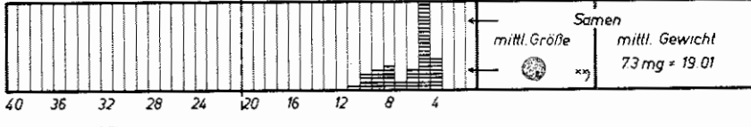
Abbildung 2. Ablenkung von Weizen, Unkrautsamen und Spreu im Windstrom
