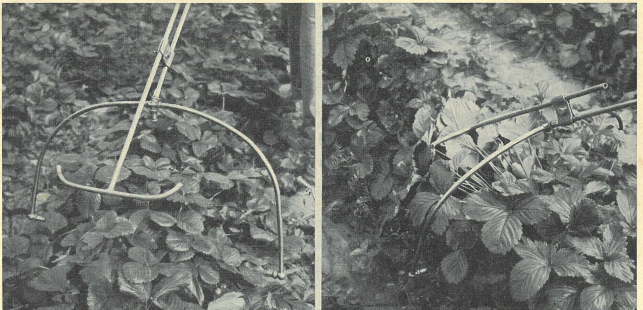
Abb. 1. Laubniederhalter an der Dreidüsigabel: a) Verschiebbare Anbringung, b) in Aktion. (Phot. H. W. K. Müller).
