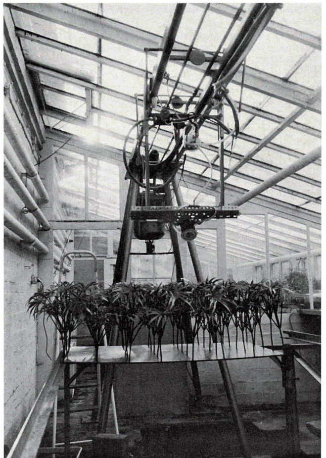
Abb. 1. Stationärer Applikationsmeßplatz, ausgerüstet mit Rotationszerstäuber.
